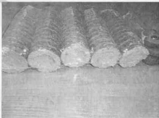
Рис. 1. Общий вид опытных образцов топливных брикетов из биомассы
