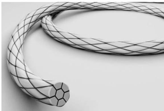
Рисунок 1 – Схематическое изображение плетеной полинити
