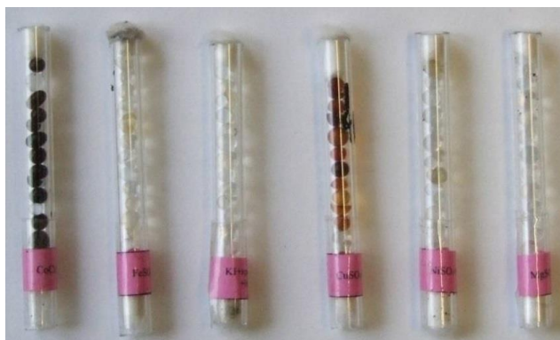
Рисунок 6 – Гранулы силикагеля после пропускания \text{H}_2\text{S}
