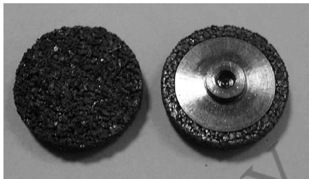
Рис. 21. Опорные площадки протеза с пористыми наружными поверхностями, контактирующими с костными тканями
