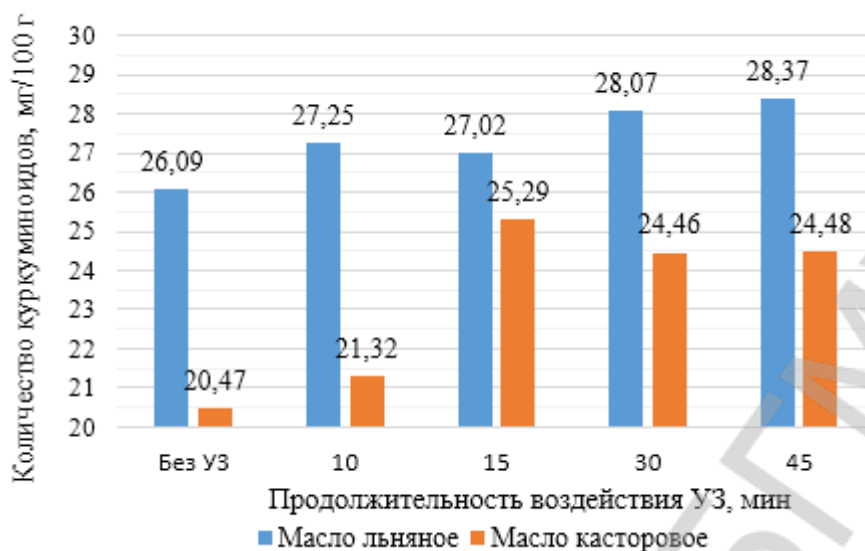
Рисунок 4 – Эффективность экстракции куркуминоидов маслами льняным и касторовым. Метод: мацерация при УЗ интенсификации процесса
