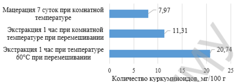
Рисунок 2 – Содержание куркуминоидов в масляных экстрактах (экстрагент – масло касторовое) при различных температурных и динамических режимах экстракции
