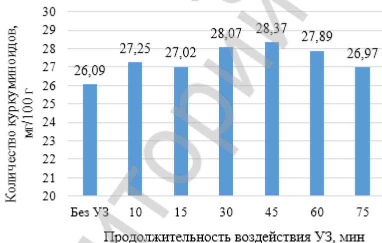
Рисунок 3 – Содержание куркуминоидов в экстрактах, полученных с использованием в качестве экстрагента масла льняного, при изменении времени воздействия ультразвука
