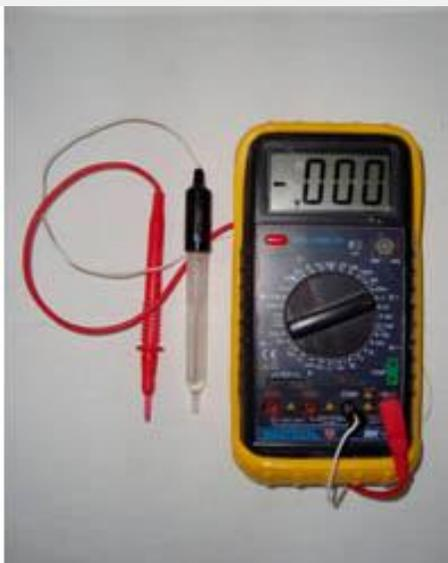
Рис 2. Комбинированный электроизмерительный прибор MASTECH
