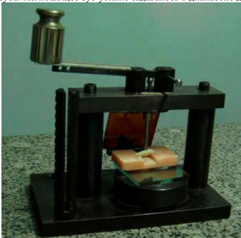
Рис.3. Нагрузочный стенд с установленным макетом.
