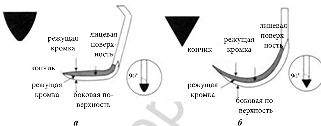
Рис. 7. Строение рабочей части инструмента:
