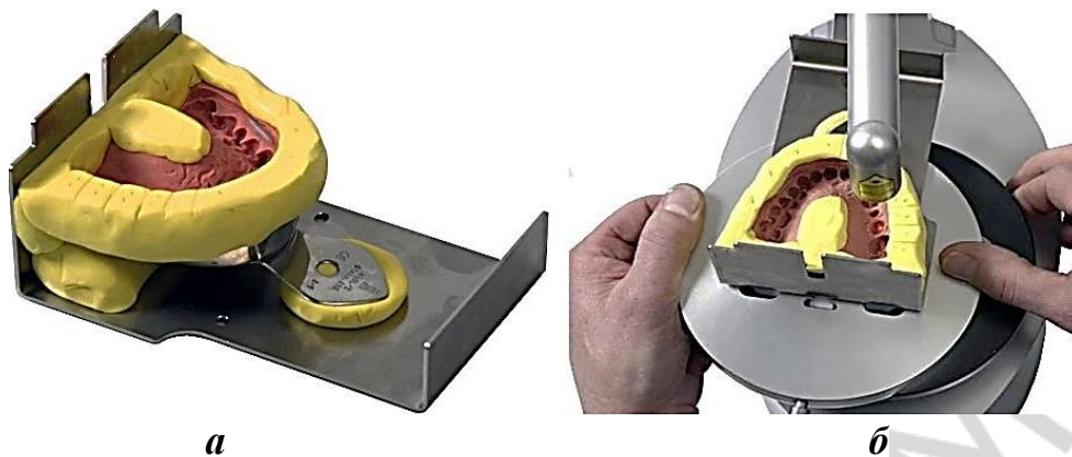
Рис. 27. Монтаж оттиска на подставке, его окантовка силиконовым материалом и установка рамки с подставкой на рабочий стол устройства для сверления цокольных пластин
