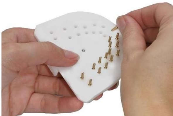
Рис. 28. Установка штифтов в цокольной пластине
