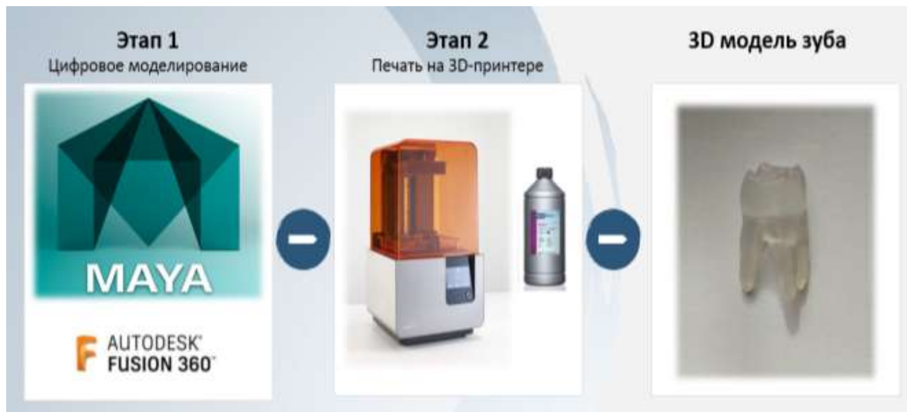
Рис. 3 – Этапы изготовления модели 3D зуб
