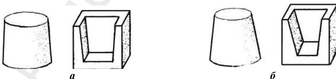
Рис. 7. Противоположные поверхности (внешние и внутренние): *а* — конус в  $6^\circ$ ; *б* — чрезмерный конус в  $20^\circ$ , который влечет за собой снижение ретенции
