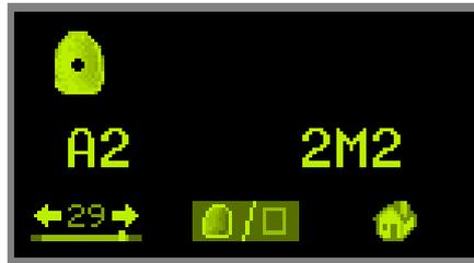
Рис. 50. Результат измерения на экране VITA Easyshade Compact
