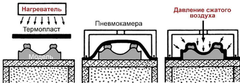
Рис. 21. Схема термопрессования полимерного материала под давлением при изготовлении индивидуальной ложки
