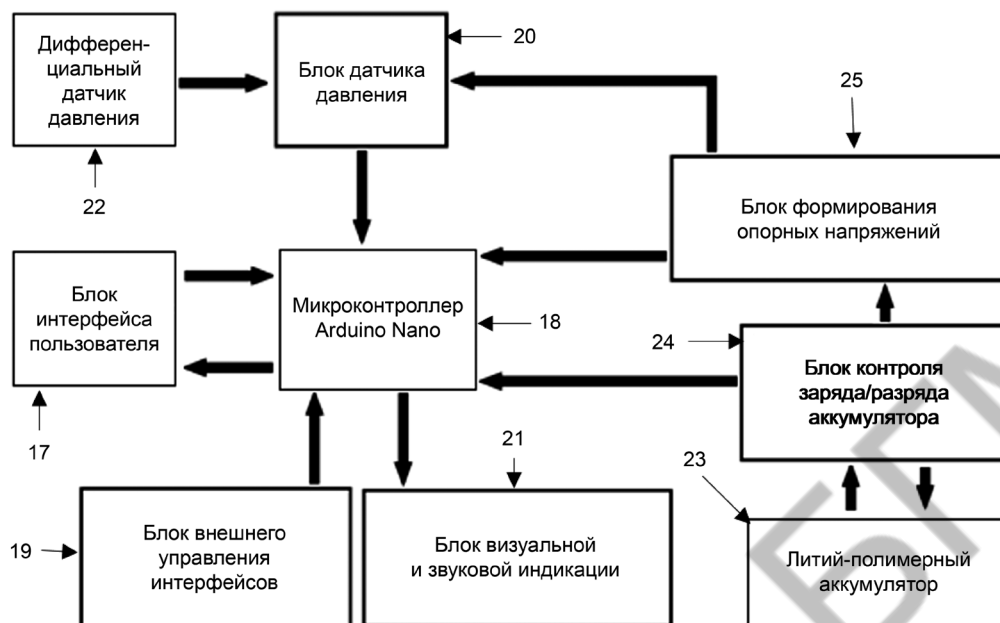
Рисунок 2. Блок-схема электронного манометра устройства для контроля герметичности желудочно-кишечного тракта при бариатрических операциях
