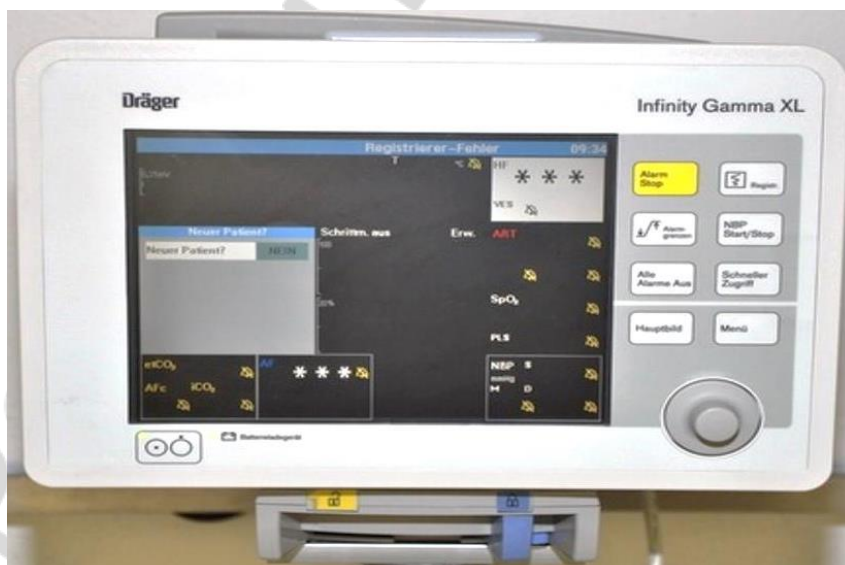
Монитор для контроля ЭКГ, ЧСС, SpO 2
