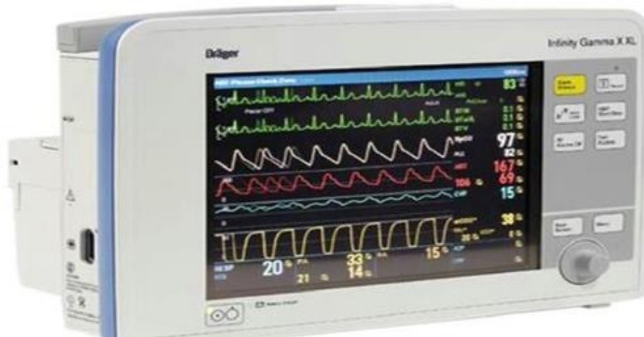
Монитор для контроля ЭКГ, ЧСС, АД, ЧД
