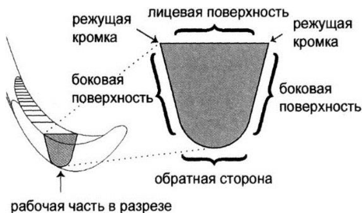
Рис. 9. Схема строения рабочей части инструмента
