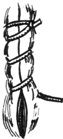
Рис. 24. Непрерывный скорняжный шов
