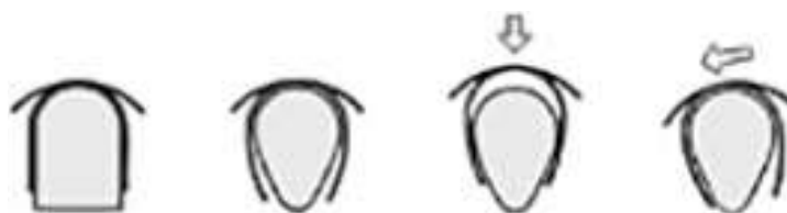
Рис. 15. Балочные замковые крепления с различными степенями свободы
