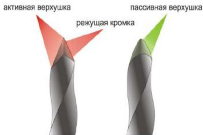
Рис. 2. Два типа верхушек эндодонтических инструментов
