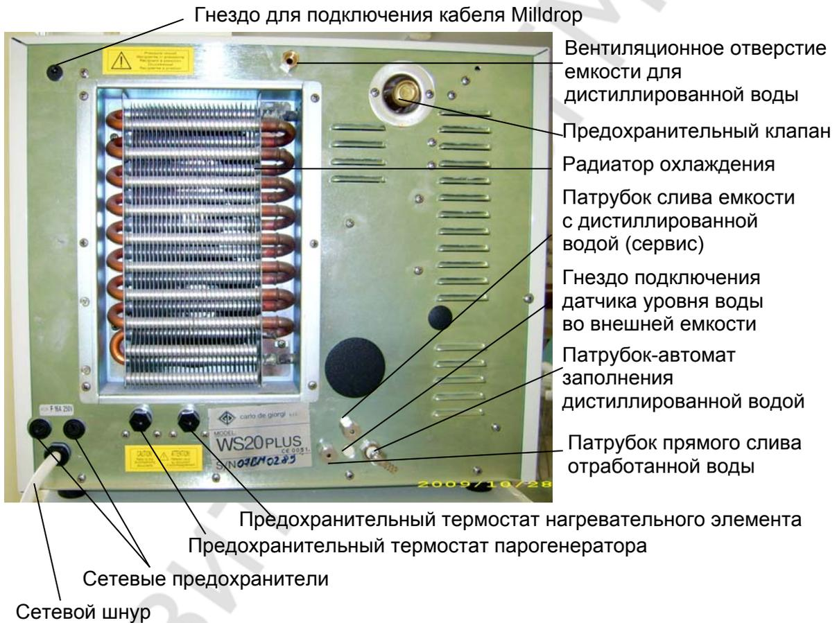
Рис. 9. Вид на заднюю панель аппарата «Millennium В»
