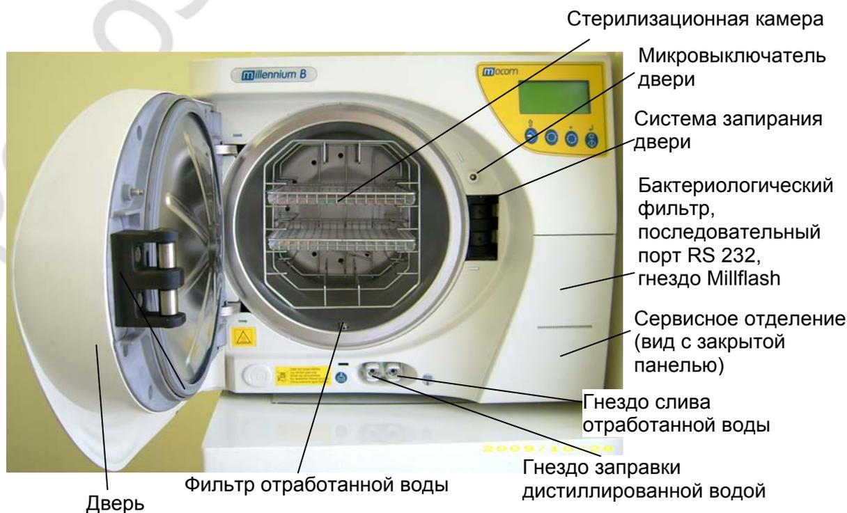
Рис. 8. Внешний вид и общие характеристики аппарата «Millennium В»
