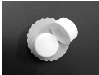
Рис. 6. Заготовка для изготовления заглушки
