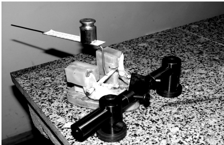
Рис. 7.3. Макет № 3, в виде зафиксированной консольно челюсти в несущей протакриловой стойке, на коронках всех зубов зафиксированы брекететы
