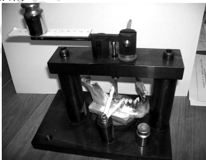
Рис. 7.7. Нагрузочный стенд, ракурс с видом на «рычаги-свидетели»
