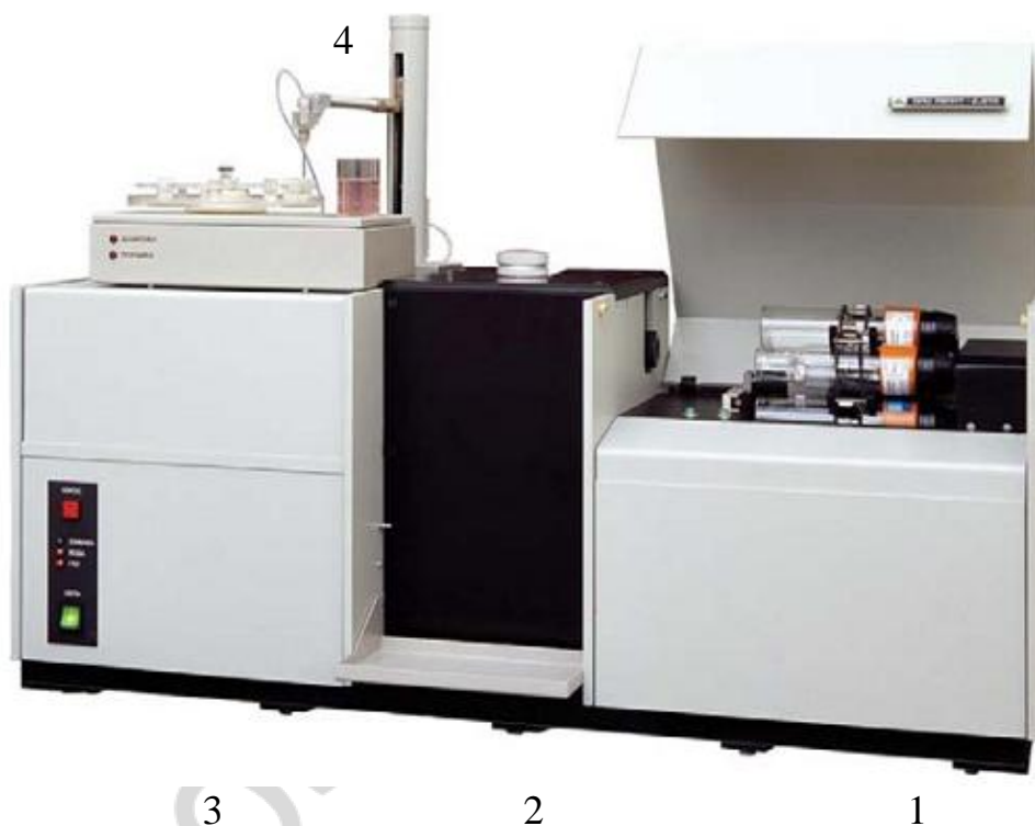
Рис. 4. Современный атомно-абсорбционный спектрометр: 1 — блок электроники и турель ламп с полым катодом; 2 — пламенная горелка в защитном корпусе; 3 — блок обработки сигнала; 4 — автосамплер (устройство ввода проб)
