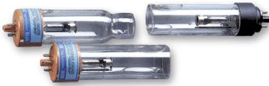
Рис. 6. Различные виды ламп с полым катодом, применяемые в методе ААС
