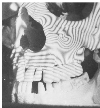
Рисунок — Интерферограмма мостовидного протеза 23xxx27 при жевательной нагрузке
