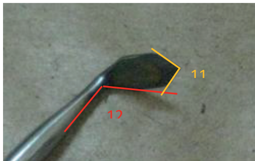
Рис.2 Инструмент для моделирования восковой композиции литой культевой штифтовой вкладки.
