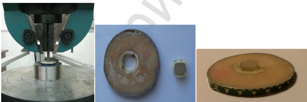
Рис. 4 –Испытания по определению силы адгезионной прочности ФМ «Мигрофил» к дентину зуба на универсальной испытательной машине «TiniusOlsenH150KU»(Англия)
