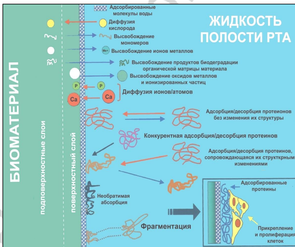
Рис. 2. Схематическое изображение некоторых реакций, ведущих к деградации материала, возможных при взаимодействии стоматологических материалов с биологической средой полости рта
