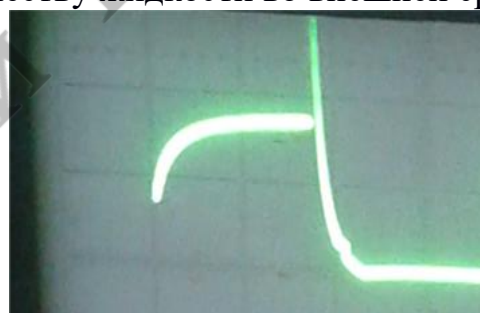
Рисунок 2 – Вид осциллограммы при измерении биоимпеданса импульсным методом
