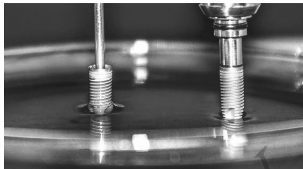
Рис. 2. Смачиваемость поверхности дентального имплантата под воздействием ультразвука (слева)
