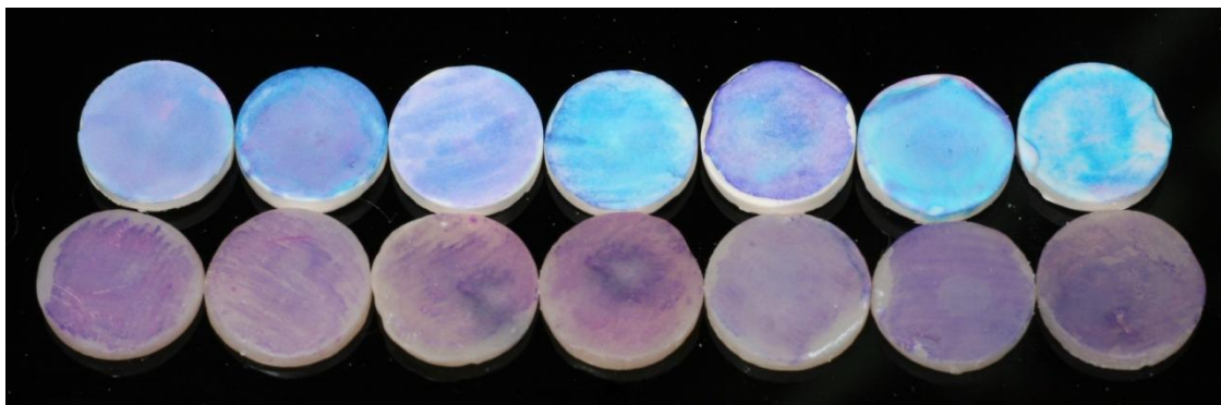
Рис. 1. Фотография серии образцов гибридного композита и СИЦ, обработанных разными порошками, после окрашивания
