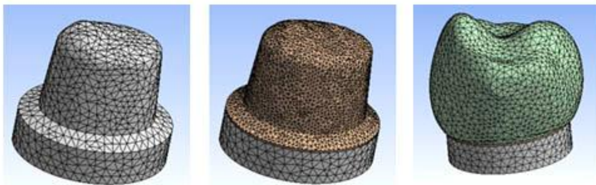
Рис. 2. Создание конечно-элементных моделей с помощью программного комплекса ANSYS Workbench 11.0
