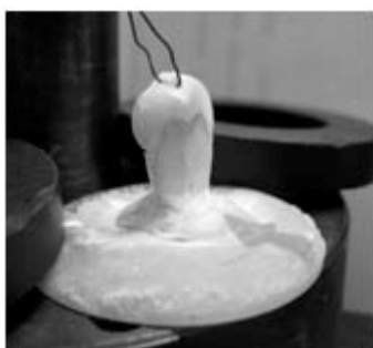
Рис. 4. Зуб подготовлен к термическим нагрузкам.
