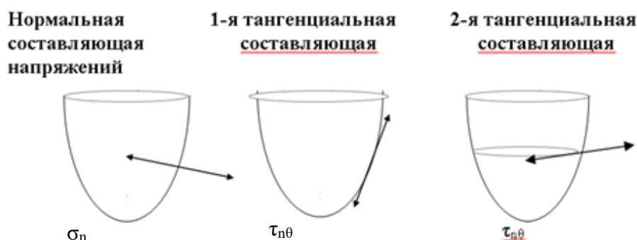
Рисунок 4 – Направления нормальных \sigma_n и касательных \tau_{ns} , \tau_{n\theta} напряжений на поверхности периодонта
