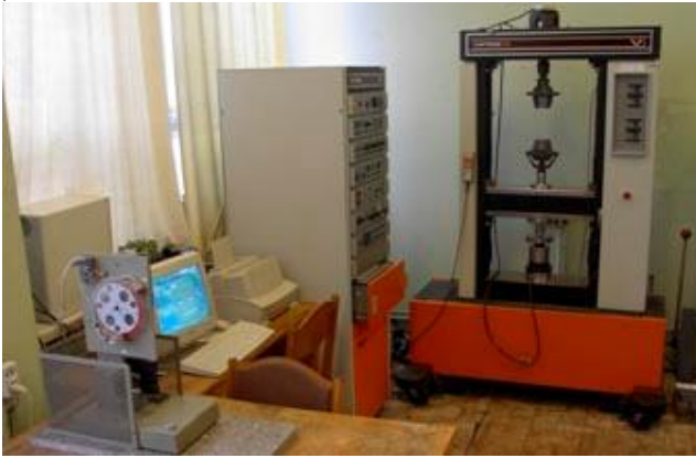
Рис.1. Комплекс механических испытаний на базе испытательной машины Instron-1195 и копра КМ-04
