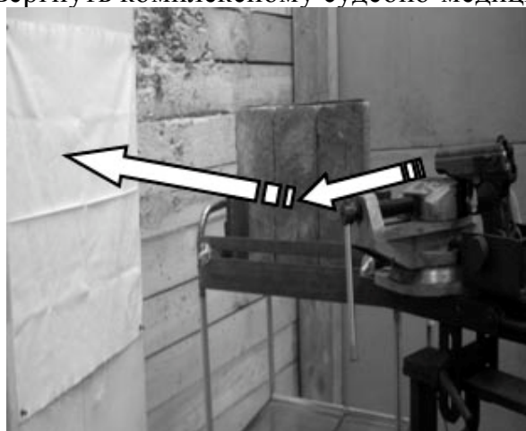
Фото 2. Взаиморасположение элементов, используемых для моделирования рикошета огнестрельного снаряда в экспериментальных условиях (стрелками показаны траектории полета пули до и после рикошета)
