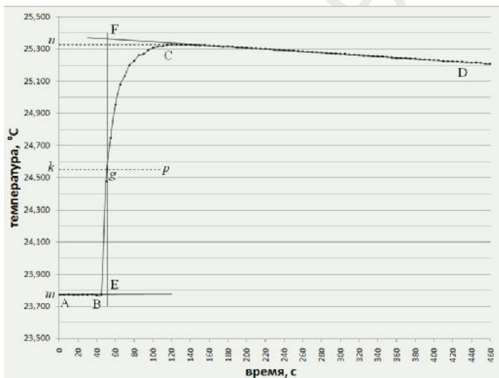
Рис. 20. Изменение температуры при нейтрализации 3,23 \text{ мл} 4,64 \text{ М} раствора \text{NH}_3 \cdot \text{H}_2\text{O}
