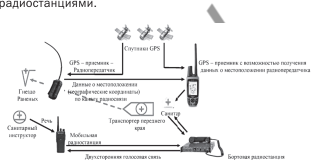
Рис. 3 – Схема передачи информации с использованием трекера при розыске гнезд раненых
