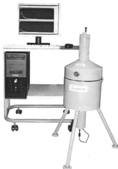
Рис. 6. Общий вид гамма-бета-спектрометра МКС-АТ1315
