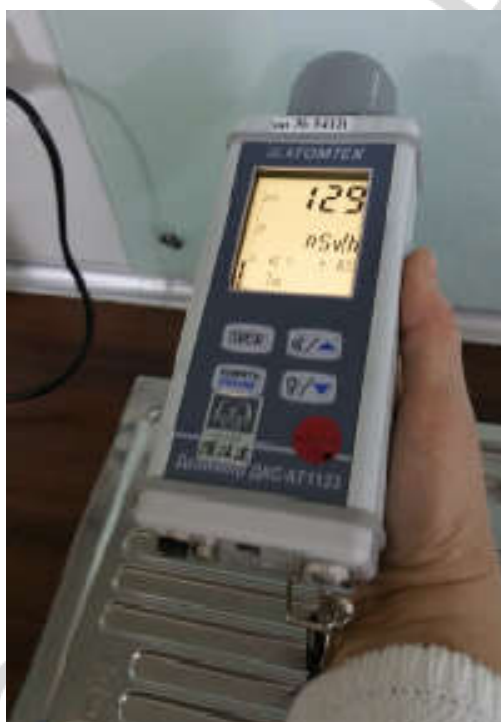
Рис. 1. Контроль эффективности стационарных средств радиационной защиты в рентгенкабинете
