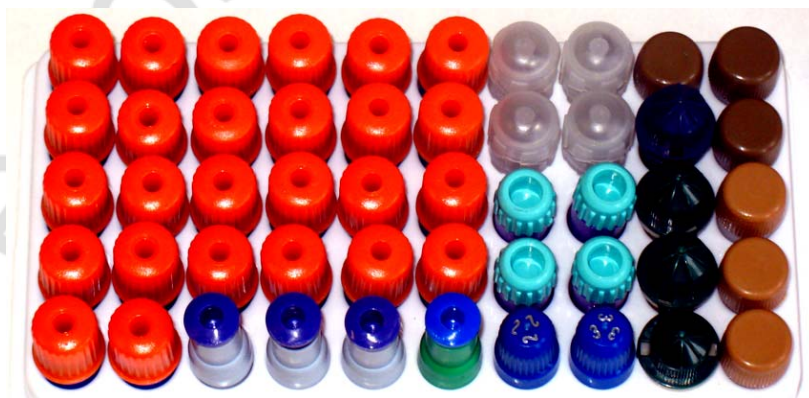
Рис. 4. Виды маркировки (цветовая, цифровая) капсул с амальгамой
