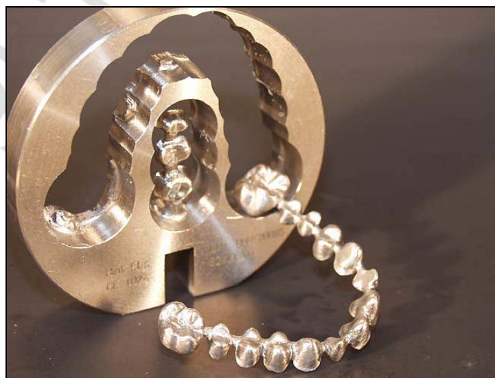
Рис. 32. Титановый каркас протеза (14 единиц), отфрезерованный станком системы DigiDent
