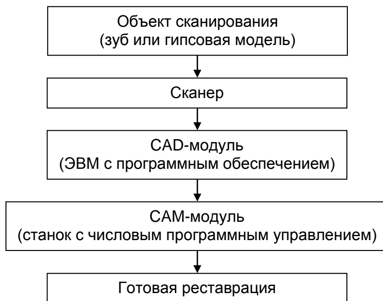
Рис. 29. Принцип работы CAD/CAM-системы
