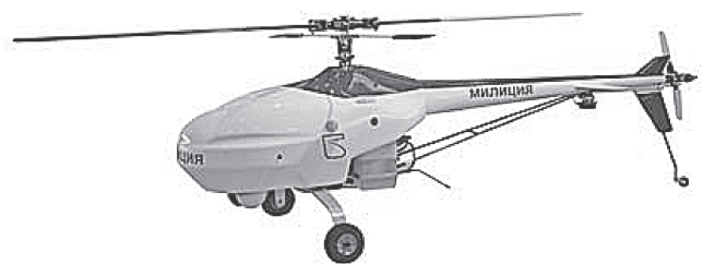
Рис. 4. Беспилотный вертолет «ZALA 421-06»
