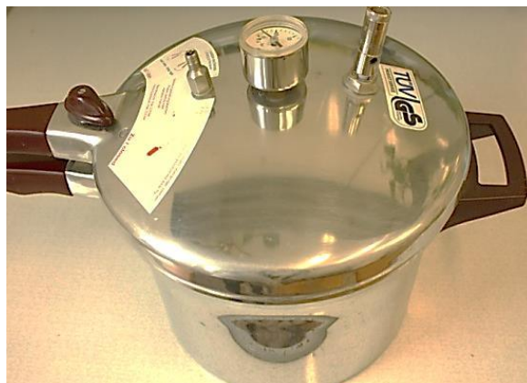
Рис. 148. Аппарат для холодной полимеризации пластмассы под давлением
