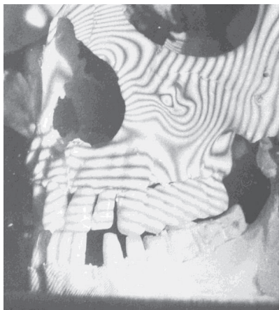
Рисунок 1 - Интерферограмма мостовидного протеза 23xxx27 при жевательной нагрузке
