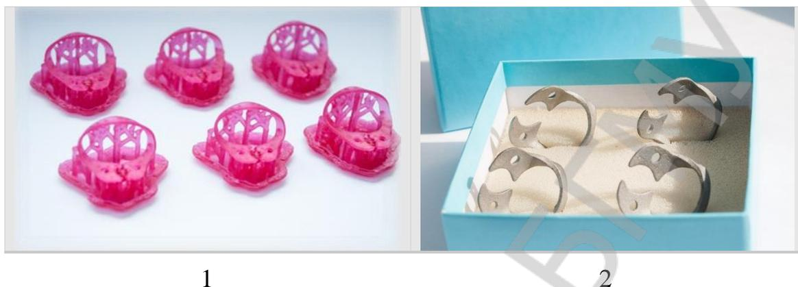
*Рисунок 2* – Напечатанные кламмера из выжигаемого полимерного материала (1) и из металла (2)
