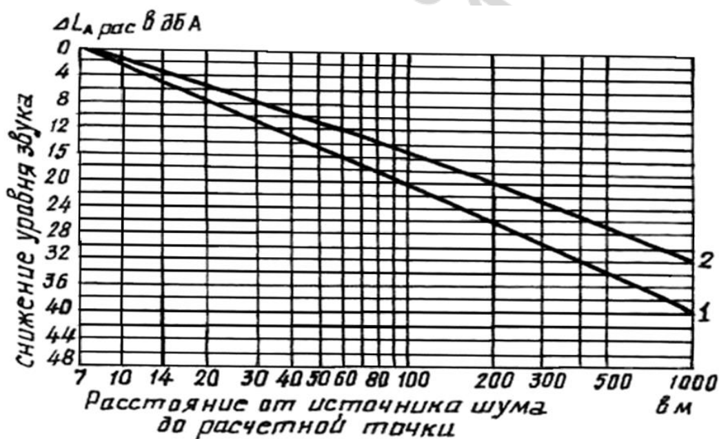
Рис. 4. Снижение уровня звука в зависимости от расстояния между источником шума и расчетной точкой:
