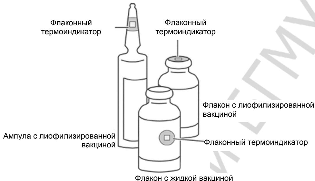
Рис. 9. Флаконный термоиндикатор на этикетке или пробке флакона
