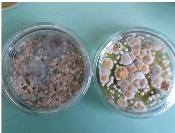
Рисунок 1. Микроскопические грибы Penicillium sp. В пробах, отобранных с поврежденных стен помещений
