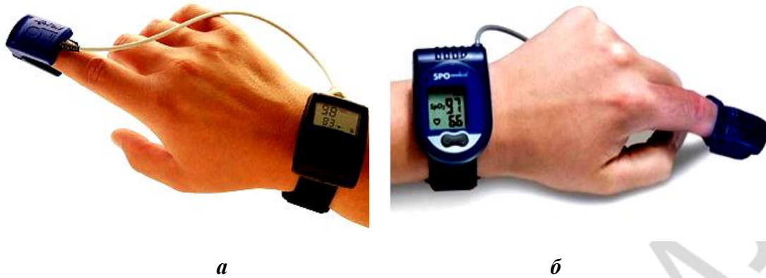
Рис. 2. Образцы фитнес-браслета (а) и наручного пульсоксиметра (б)
