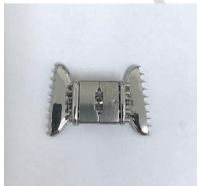
Рис. 50. Изготовленный экспандер в сборе
