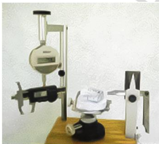
Рис. 27. Аппарат TARG с системой измерения толщины
